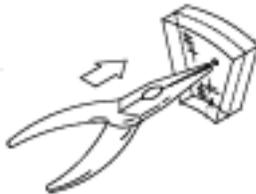
Drücken Sie die Spitze von der Rückseite aus dem Segment. Öffnen Sie auf keinen Fall andere Teile des Dartboards.
